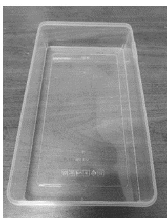
شکل ۳- ب: قالب برای تهیه نمونه جهت انجام آزمایش پنترومتر
