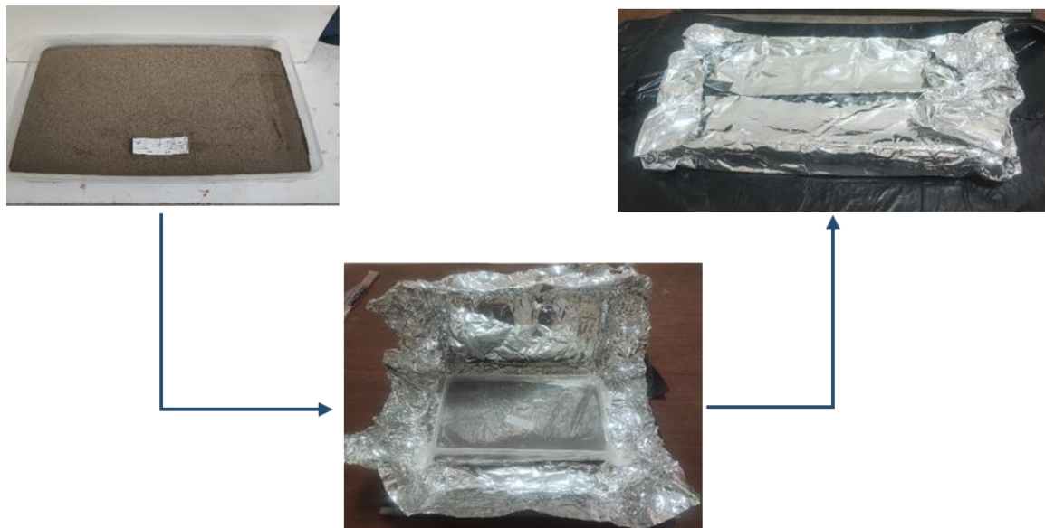
شکل ۶: ساخت نمونه جهت انجام آزمایش پنترومتر و عمل آوری آن
