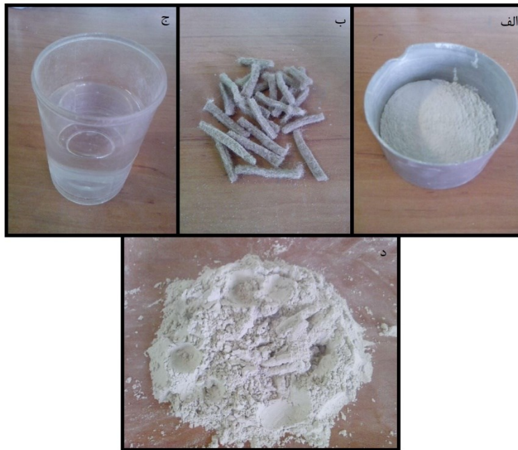
شکل ۳. اختلاط مصالح: الف) خاک رس کائولینیت، ب) الیاف موکت، ج) آب مورد نیاز برای مخلوط و د) مخلوط یکنواخت
